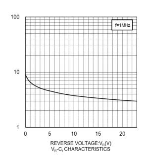
CAPACITANCE BETWEEN TERMINALS:C<sub>t</sub>(pF)
