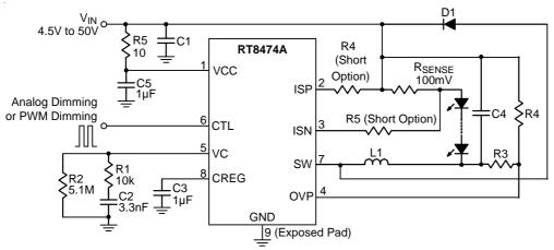
Note :  $V_{IN}$ ,  $V_{SW}$ ,  $V_{ISP}$ ,  $V_{ISN} < 50V$
